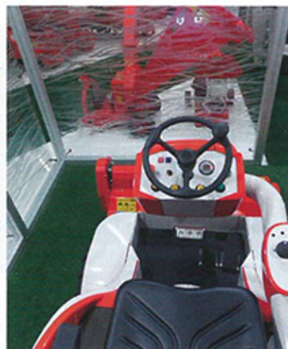
Le poste de conduite, dont la position est réversible à 180°.
